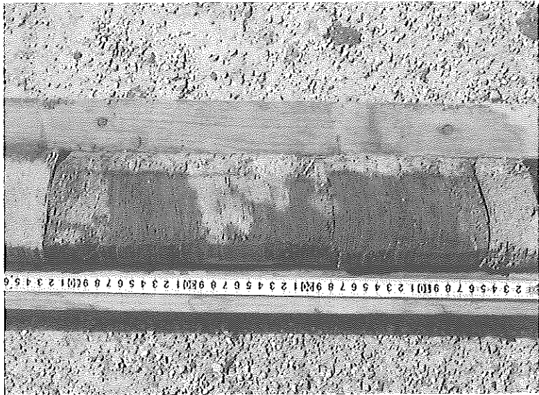
写真4.1.1-29 A-5から採取したコア (43cmの位置に年輪の不連続部が見られた)
