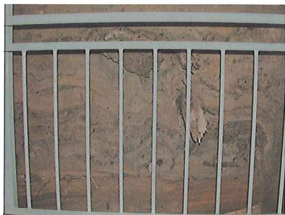
写真4.3-6 岩屑なだれ堆積物の中部層で見られる、 変形した火山灰層 波線の下は流木、格子間の幅は約12cm
