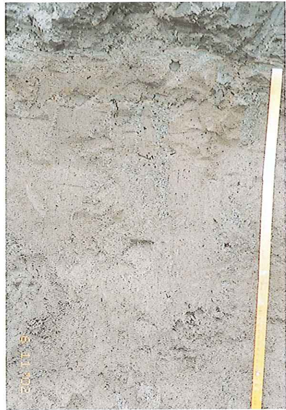
写真4.3-10 ガス抜けパイプ状構造 粒度の粗い部分。物差しの見えている部分の長さは65cm
