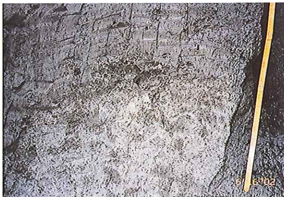
写真4.3-9 岩屑なだれ堆積物と火砕流堆積物の境界 物差しの見えている部分の長さは60cm
